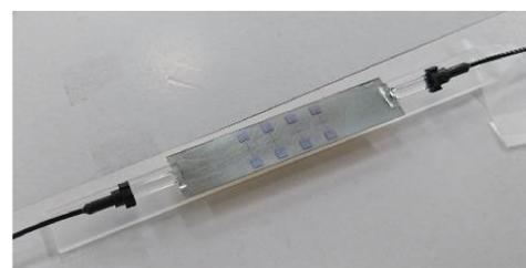
試作したアンテナ電極
